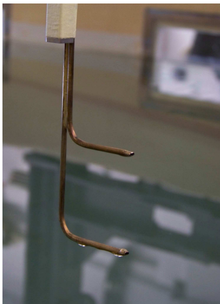
Bild 2. Pitotrohre zur Differenzdruckmessung
